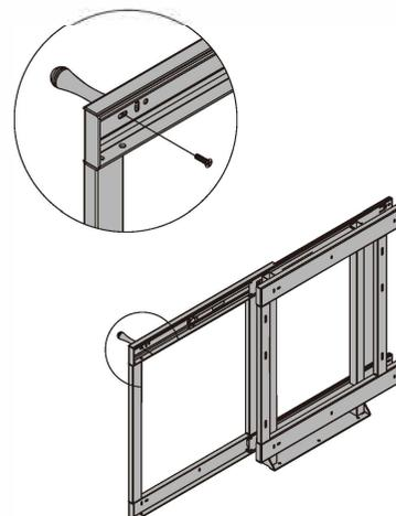
Шаг 1: Вытащите раму, установите ручку на раму с помощью винтов.
