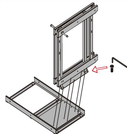
Шаг 2: Зафиксируйте винты шестигранным ключом, закрепите раму и основание.
